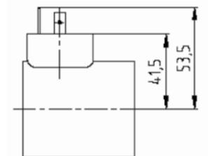
[9] Электромагнитные катушки со стандартным электрическим соединением согласно ISO 4400 / DIN 43650, для источника постоянного тока
