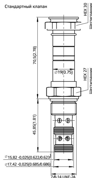
Клапаны EV3\*.78 устанавливаются в 7/8"-14 UNF. Проверьте соответствующее состояние и расположение уплотнений, затем заверните клапан в камеру и зафиксируйте путем затяжки шестигранника под ключ 27 мм с крутящим моментом приблизительно 45 Нм
