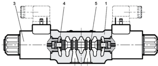
Золотник 5 смещается в корпус клапана 1 под действием пружин 4 и электромагнитов. Золотник 5, в зависимости от его формы и положения в корпусе клапана 1, открывает и/или закрывает проходы между портами P, A, B и T, за счет чего регулируется направление гидравлического потока.
