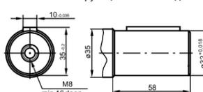
**CB** Ø35 цилиндрический, Призматическая шпонка A10x8x45 DIN 6885
