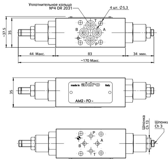
Все клапаны AM2-FO\* соответствуют стандартам ISO и СЕТОР для размеров монтажных поверхностей. Высота клапанов составляет 35 мм. Утечка между клапаном и монтажной поверхностью предотвращается посредством полного прижима к седлам 4 уплотнительных колец типа OR. На установочной поверхности всех клапанов предусмотрено цилиндрическое отверстие диаметром 4 мм, на уплотнительной поверхности – направляющий штифт диаметром 3 мм, в соответствии с нормами. При необходимости штифт без труда демонтируется.
