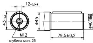
**CO** Ø1½" цилиндрический, Призматическая шпонка ¾"x¾"x2¼" DIN6885
