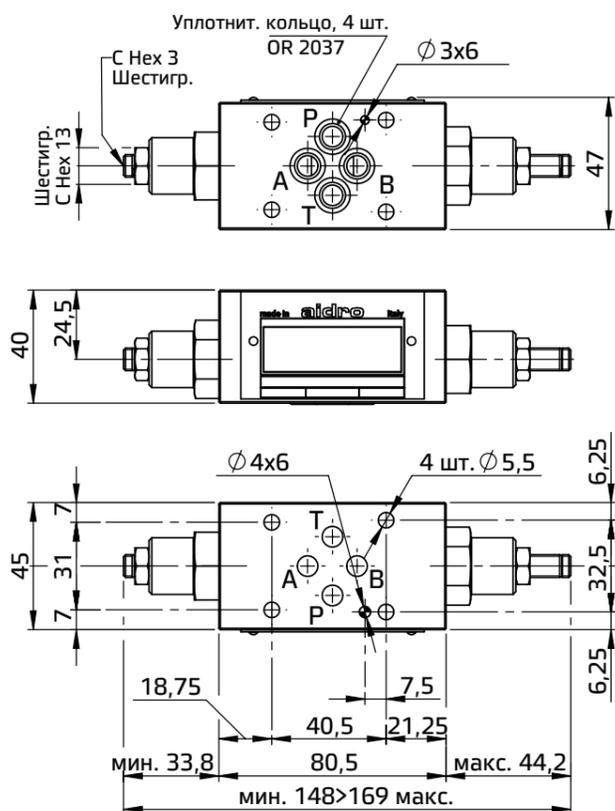
Все модульные клапаны AM3-FX\* соответствуют стандартам ISO и СЕТОР для размеров монтажных поверхностей. Высота клапанов составляет 40 мм. Утечка между клапаном и монтажной поверхностью предотвращается посредством полного прижима к седлам 4 уплотнительных колец типа OR. На установочной поверхности всех клапанов предусмотрено цилиндрическое отверстие диаметром 4 мм, на уплотнительной поверхности – направляющий штифт диаметром 3 мм, в соответствии с нормами ISO и СЕТОР.
