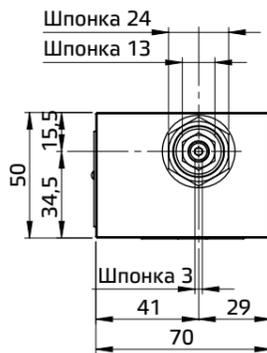
Все модульные клапаны AM5-FC-\* соответствуют стандартам ISO и СЕТОР для размеров монтажных поверхностей (см. также первую страницу). Высота клапанов составляет 50 мм. Утечка между клапаном и монтажной поверхностью предотвращается посредством полного прижима к седлам 4 уплотнительных колец типа OR или уплотнений квадратного сечения типа Quad-Ring.
