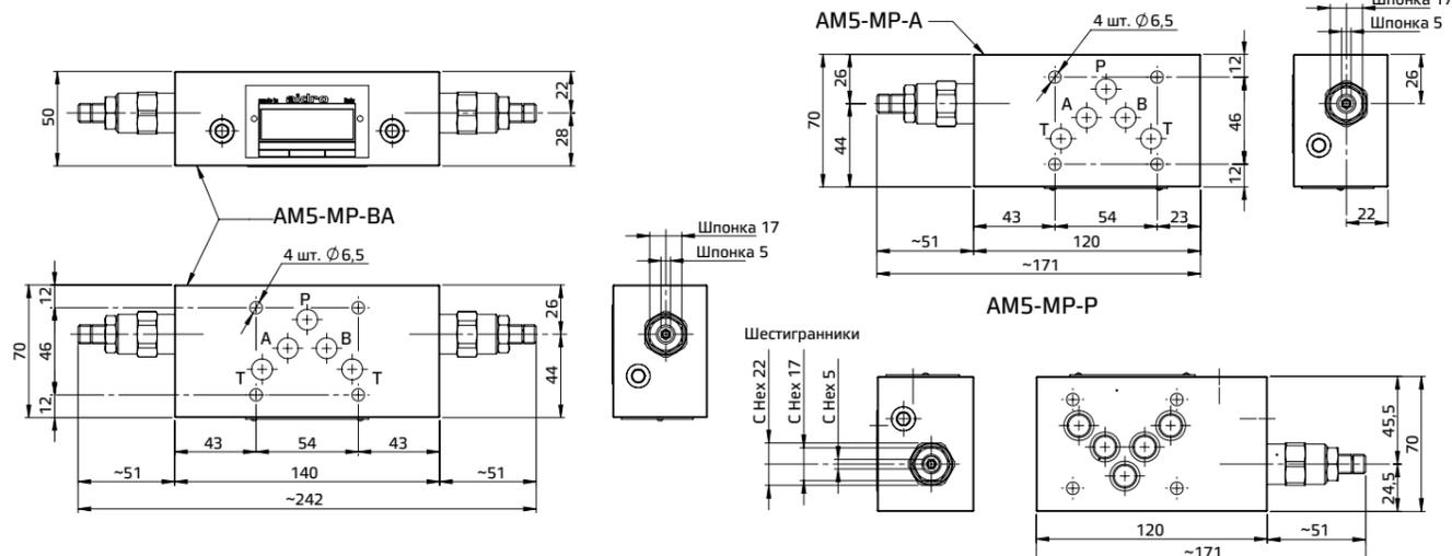
Редукционные клапаны модульного монтажа
