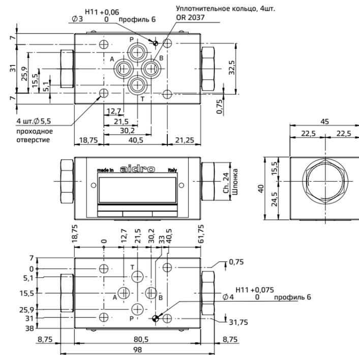
Все обратные клапаны АМЗ-ФХ\* соответствуют стандартам ISO и СЕТОР для размеров монтажных поверхностей. Высота клапанов составляет 40 мм. Утечка между клапаном и монтажной поверхностью предотвращается посредством полного прижима к седлам 4 уплотнительных колец типа OR. На установочной поверхности всех клапанов предусмотрено цилиндрическое отверстие диаметром 4 мм, на уплотнительной поверхности – направляющий штифт диаметром 3 мм, в соответствии с нормами ISO и СЕТОР.
