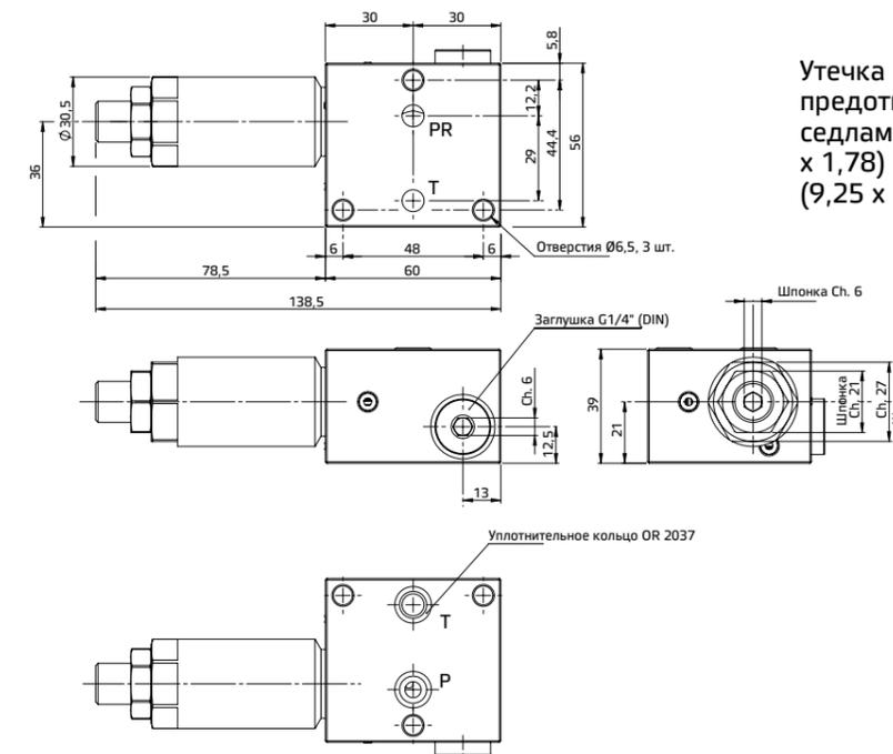
Утечка между клапаном и монтажной поверхностью предотвращается посредством полного прижима к седлам уплотнительных колец типа OR 2037 (9,25 x 1,78) или колец квадратного сечения Quad-Ring (9,25 x 1,68 x 1,68 мм).
