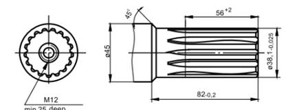
**K** – коническое 1:10, Призматическая шпонка B12x8x28 DIN 6885
