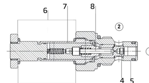
Тарелка 4 приводится в действие и удерживается в нормально закрытом положении в седле 5 посредством управления. Когда к электромагниту 6 подводится питание, подвижный якорь 7 и управляющий штифт 8 смещаются, и тарелка, разбалансированная под действием давления, открывается, пропуская поток от 2 до 1.
