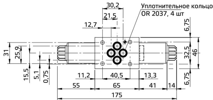
Все клапаны HD33-\* соответствуют стандартам ISO и СЕТОР для размеров монтажных поверхностей и высоты клапанов. При сборке на монтажной плите клапаны HD33-\* должны крепиться 4-мя болтами M5x45 (или M5x\*\*, в зависимости от количества модулей), затягиваемыми с применением крутящего момента 8 Нм. Утечка между клапаном и монтажной поверхностью предотвращается посредством полного прижима к седлам 4 уплотнительных колец OR 9,25x1,78.
