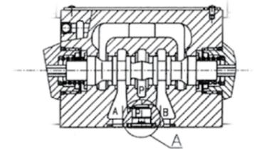
Герметичность элементов в порте P обеспечивается уплотнительным кольцом типа OR, 9,25x1,78 мм (например, OR 110-2037).
