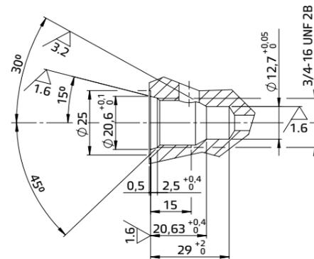
Многослойный корпус для картриджных клапанов по стандарту SAE 2-линейных 3/4" 16UNF в линиях A и B **AM3-\*-C**
