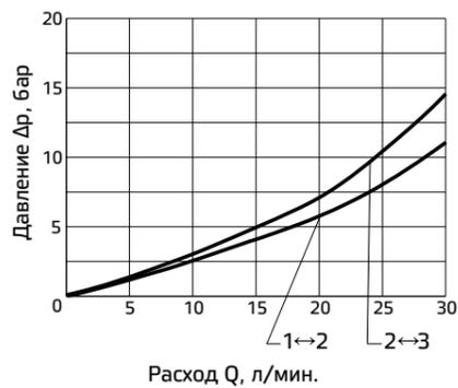
Типовые кривые р-Q рабочих пределов для максимальной гидравлической мощности, передаваемой клапанами EVX-\*-C5.
