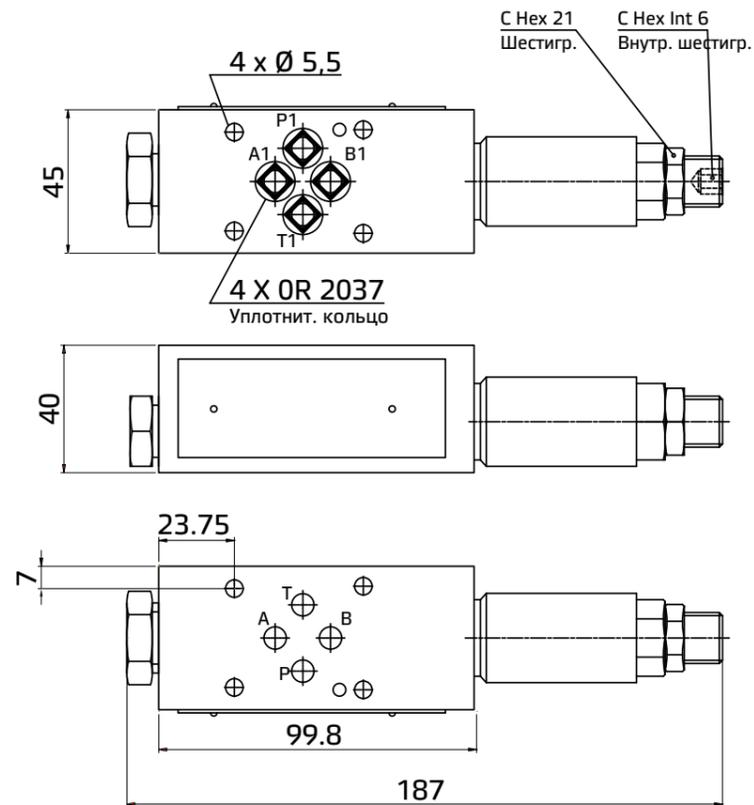
Все модульные клапаны AM3-\* соответствуют стандартам ISO и CETOP для размеров монтажных поверхностей. Утечка между клапаном и монтажной поверхностью предотвращается посредством полного прижима к седлам 4 уплотнительных колец типа OR.
