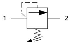
После приемочных испытаний клапан соответственно настраивается на 100, 180 и 350 бар (±10%) с расходом 5 л/мин.
