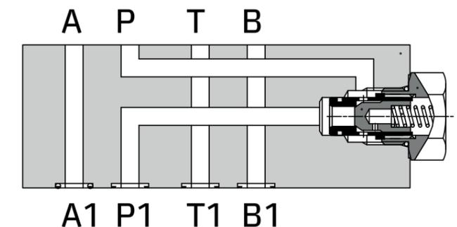
Жидкость поступает свободно по линиям А, В и Т. Когда давление в P1 превышает сумму давления в P и давления, возникающего вследствие натяжения пружины, тарелка смещается в осевом направлении, и жидкость поступает из P1 в P. Обратный поток перекрывается (без утечек) тарелкой, которая удерживается в своем седле пружинной.
