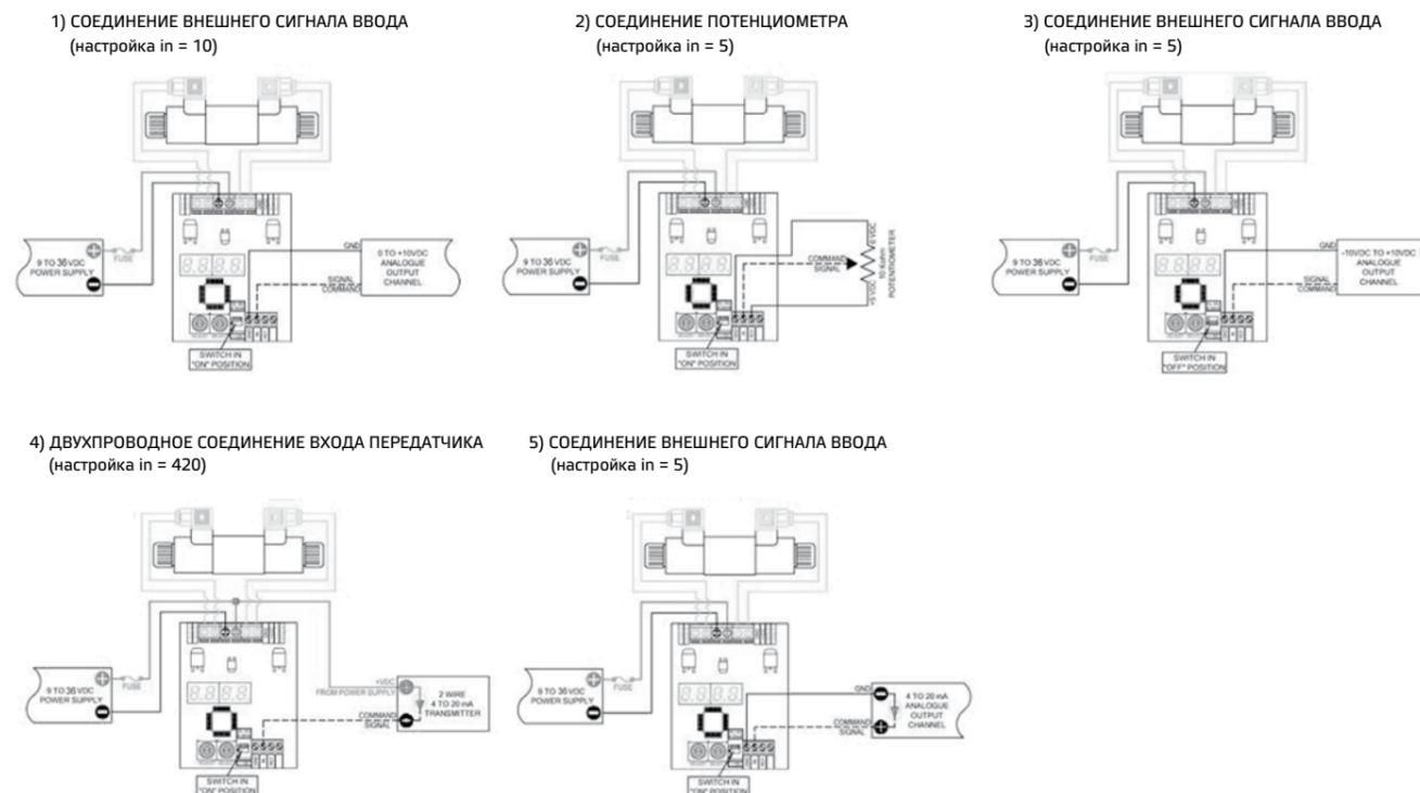
Примечание: Для драйверов с командным входом 0–5 В постоянного тока или 0–10 В постоянного тока рекомендуется использовать независимые отрицательные провода для источника питания и для аналогового выходного канала (ПЛК/ПК), чтобы поддерживать точность командного сигнала в случае перепада напряжения в кабелях большой длины.
