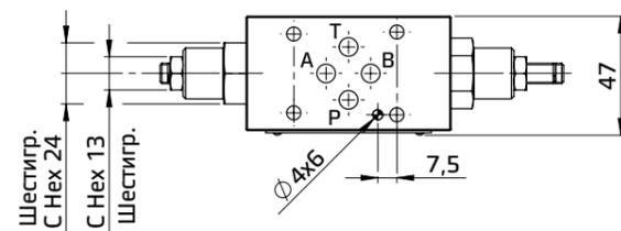
Все дроссели AM3-FC\* соответствуют стандартам ISO и CETOP для размеров монтажных поверхностей. Высота клапанов составляет 40 мм.
