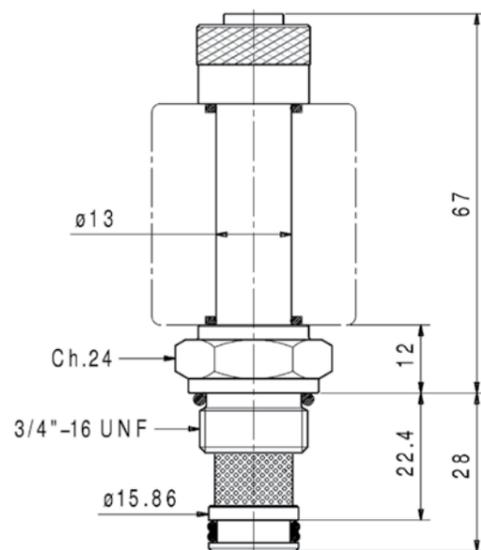
Клапаны EVD2.34/2 устанавливаются в седло 3/4"-16 UNF  $\varnothing$ 12,7 мм. Проверьте соответствующее состояние и расположение уплотнений, затем заверните клапан в камеру и зафиксируйте путем затяжки шестигранника под ключ 24 мм с крутящим моментом приблизительно 45 Нм.
