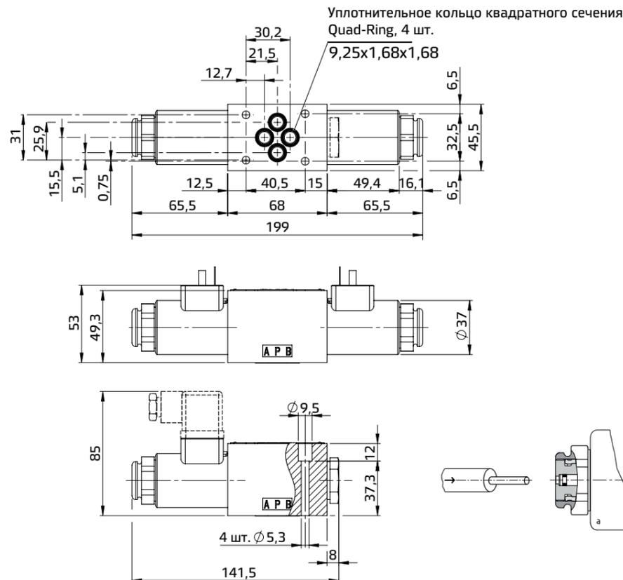
Все клапаны HD3-\* соответствуют стандартам ISO и СЕТОР для размеров монтажных поверхностей (см. 8) и высоты клапанов. При сборке на монтажной плите клапаны HD3-\* должны крепиться 4-мя болтами M5x45 (или M5x\*\*, в зависимости от количества модулей), затягиваемыми с применением крутящего момента 8 Нм. Утечка между клапаном и монтажной поверхностью предотвращается посредством полного прижима к седлам 4 уплотнений – уплотнительных колец квадратного сечения типа QuadRing 9,25x1,68x1,68.
