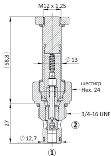
Клапаны EV\*.34 устанавливаются в седло 3/4"-16 UNF Ø12,7 мм. Проверьте соответствующее состояние и расположение уплотнений, затем заверните клапан в камеру и зафиксируйте путем затяжки шестигранника под ключ 24 мм с крутящим моментом приблизительно 45 Нм.
