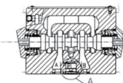
Герметичность элементов в порте P обеспечивается уплотнительным кольцом типа OR, 9,25x1,78 мм (например, OR 110-2037).
