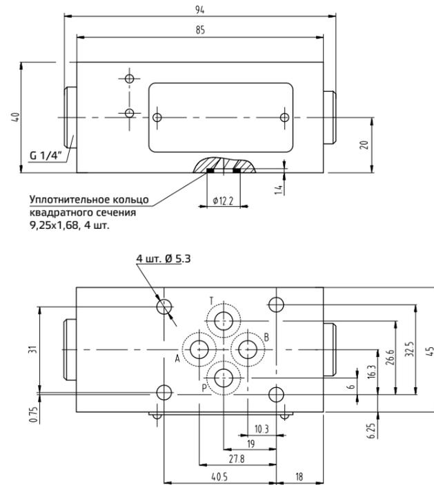
Все модульные клапаны АМЗ-РС-\* соответствуют стандартам ISO и СЕТОР для размеров монтажных поверхностей и для высоты клапанов 45 мм. Утечка между клапаном и монтажной поверхностью предотвращается посредством полного прижима к седлам 4 уплотнительных колец типа OR 2037.
