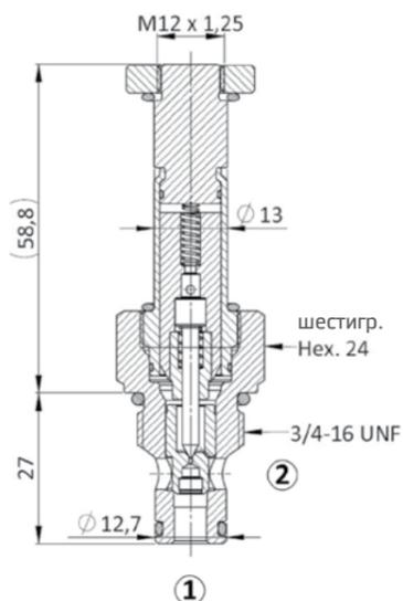
Клапаны EV\*.34 устанавливаются в седло 3/4"-16 UNF Ø12,7 мм. Проверьте соответствующее состояние и расположение уплотнений, затем заверните клапан в камеру и зафиксируйте путем затяжки шестигранника под ключ 24 мм с крутящим моментом приблизительно 45 Нм.
