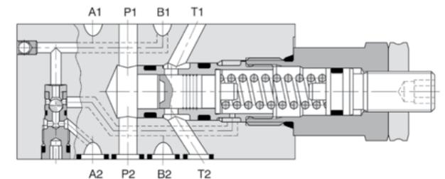
3-линейный клапан-компенсатор давления прямого действия модульной версии с монтажной поверхностью согласно стандартам СЕТОР и ISO. Его функция заключается в поддержании перепадов давления DP между линиями Р и А или В. Как правило, используется вместе с направляющими пропорциональными клапанами для регулировки потока независимо от изменений давления. Выбор давления управления в линиях А и В осуществляется автоматически обратным клапаном, встроенным в клапан-компенсатор.
