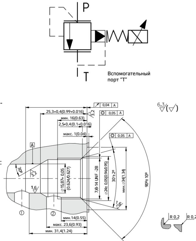
Клапан предназначен для непрерывной регулировки давления в контуре. Управление клапаном осуществляется на стадии управления. Повышается/понижается давление Р в системе пропорционально возбуждающему току в электромагните. Для автоматического освобождения воздуха из клапана рекомендуется устанавливать клапан в вертикальном положении с катушкой в нижней части. Если это невозможно, следует задействовать стравливающий винт, чтобы обеспечить надлежащее функционирование клапана.
