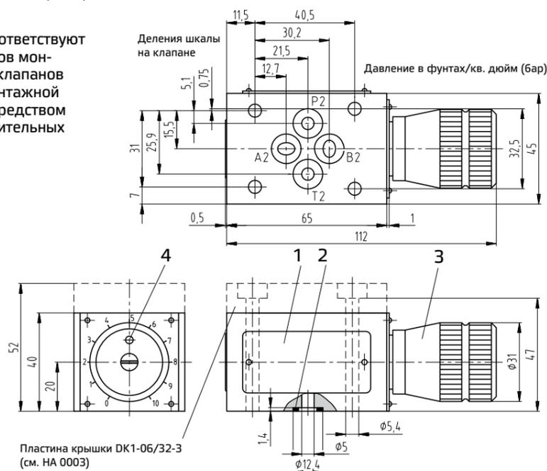
Регуляторы расхода скомпенсированные по давлению модульного монтажа **AM3-Q\*-A** 40 л/мин – 32 МПа (320 бар)
