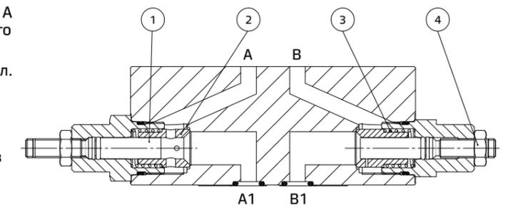
Жидкость поступает свободно по линиям P и T. В рабочих линиях A и/или B с регулировкой жидкость поступает в направлении A1 → A (и/или B1 → B), преодолевая усилие пружины, действующее на втулку. Жидкость поступает в направлении A → A1 (и/или B → B1) через отверстия втулки, вдавливаемой в седло. Дросселирующая ось, смещаемая путем завинчивания и блокировки при помощи гайки, частично преграждает регулирующие отверстия, за счет чего расход полностью зависит от действующего перепада давлений.
