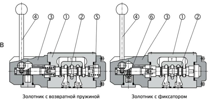
Направляющие клапаны с ручным управлением используются, главным образом, для контроля запуска, остановки и направления потока жидкости. В их состав входит корпус 1 с управляющим золотником 2 и приводной секцией 3. Приводная секция включает либо ручной рычаг 4 и одну или две возвратные пружины 5, либо узел фиксатора 6. Узел фиксатор удерживает золотник в его последнем положении смещения.
