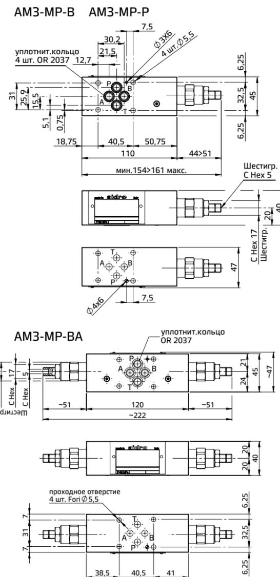
Редукционные клапаны модульного монтажа
