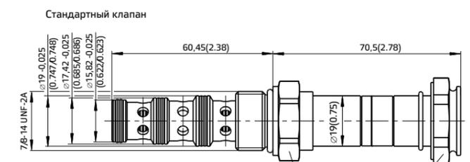
Клапаны EV4\*.78 устанавливаются в седло 7/8"-14UNF. Проверьте соответствующее состояние и расположение уплотнений, затем заверните клапан в камеру и зафиксируйте путем затяжки шестигранника под ключ 27 мм с крутящим моментом приблизительно 45 Нм.
