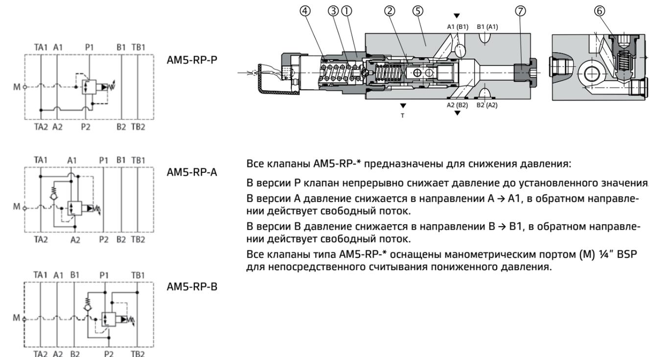
Все клапаны AM5-RP-\* предназначены для снижения давления:
