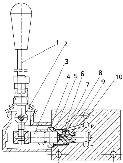
При всасывании поршень 1 перемещается назад, и жидкость поступает из порта Т через обратный клапан 4, при этом обратный клапан 2 остается в закрытом положении. При перемещении рычагом поршня 1 вперед обратный клапан 4 удерживается в закрытом положении пружиной 3, при этом обратный клапан 2 открывается и пропускает жидкость в линию нагнетания.
