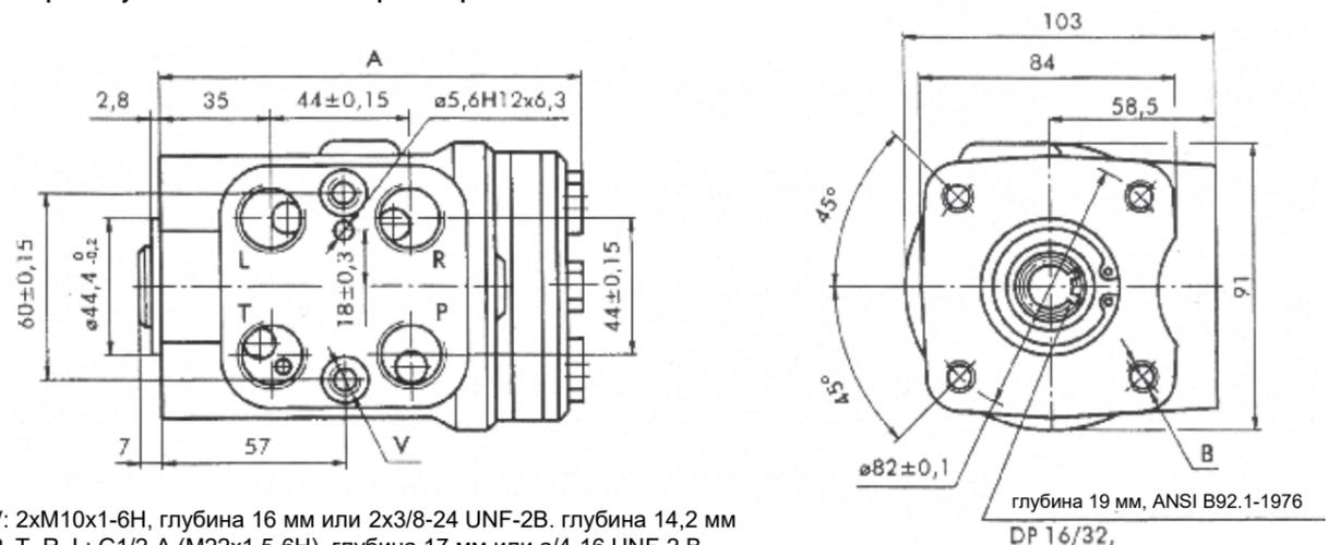
V: 2xM10x1-6H, глубина 16 мм или 2x3/8-24 UNF-2B, глубина 14,2 мм
