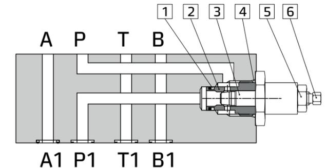
Жидкость свободно поступает по линиям А, В и Т. Поток жидкости в линии P регулируется клапаном с дросселем переменного сечения, включающего иглу 3 (положение которой устанавливается регулировочным винтом 6), которая изменяет поперечное сечение кольцевого прохода.
