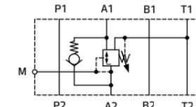
Пониженное давление достигается путем дросселирования потока в золотнике 2, которое балансируется, с одной стороны – путем снижения давления, с другой стороны – при помощи пружины.
