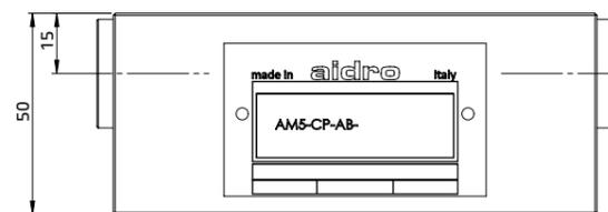
Все модульные клапаны AM5-CP-\*0 соответствуют стандартам ISO и СЕТОР для размеров монтажных поверхностей и для высоты клапанов (50 мм). Утечка между клапаном и монтажной поверхностью предотвращается посредством полного прижима к седлам уплотнений (уплотнительных колец типа OR или уплотнительных колец квадратного сечения типа Qaud-Ring).
