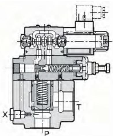
GMG\*-/60 – предохранительный клапан с пилотным управлением, доступен в 5 версиях и максимум с 3 вариантами выбора значений давления. Для установки 2-го и 3-го значений клапан разгрузки давления должен быть установлен между основным клапаном и электромагнитным клапаном. Клапаны поставляются, как правило, с регулировочным винтом с шестигранной головкой (по запросу клапан оснащается рукояткой SICBLOC для регулировки основного давления).
