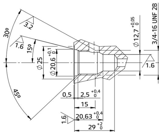
Многослойный корпус СЕТОР 03 для 2-линейных картриджных клапанов 3/4" 16 UNF в линиях А и В, стандарт SAE AM3-\*-X
