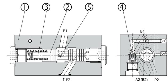
Клапаны AM3-PC-\* представляют собой 2-линейные компенсаторы давления прямого действия. Основными частями таких клапанов являются корпус 1, управляющий золотник 2, пружина 3 и логический клапан 4. Пружина 3 удерживает золотник в открытом положении между P1 и P2, если разница давлений между P1 и A (P1-B) составляет меньше p = 10 бар. Когда разница давлений превышает значение p = 10 бар, золотник смещается относительно пружины, пока не восстанавливается требуемая разница давлений.
