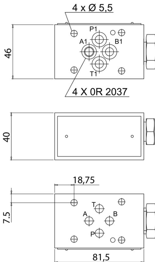
Все модульные клапаны AM3-\* соответствуют стандартам ISO и СЕТОР для размеров монтажных поверхностей и высоты клапанов (40 мм). Утечка между клапаном и монтажной поверхностью предотвращается посредством полного прижима к седлам 4 уплотнительных колец типа OR.
