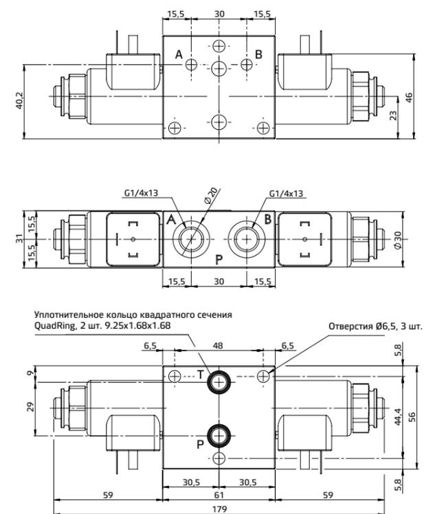
Плита для последовательного соединения клапанов HDF-ES, AMF-PM-TP
