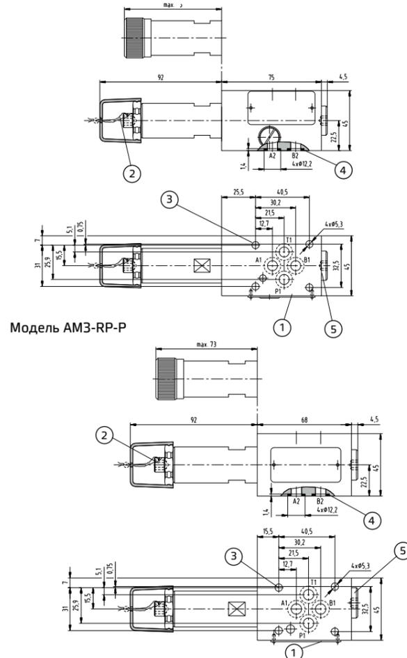
Все модульные клапаны АМЗ-РР\* соответствуют стандартам ISO и СЕТОР для размеров монтажных поверхностей и для высоты клапанов 45 мм. Утечка между клапаном и монтажной поверхностью предотвращается посредством полного прижима к седлам 4 уплотнительных колец типа OR 2037.
