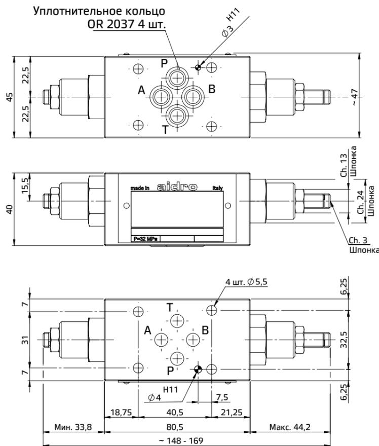
Все клапаны AM3-FO\* соответствуют стандартам ISO и CETOP для размеров монтажных поверхностей. Высота клапанов составляет 40 мм.
