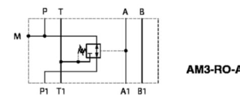
Все клапаны АМЗ-RO-\* – 3-линейные, прямого действия: Если давление в регулируемой камере превышает значение регулируемого понижаемого давления, клапан осуществляет нагнетание в линию Т (при давлении выше понижаемого давления, см. графики), при этом он действует как предохранительный или разгрузочный клапан.
