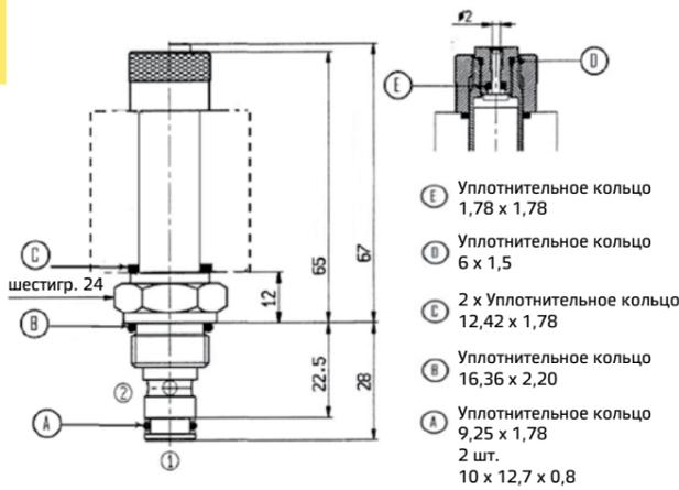
Клапаны EV\*.34 устанавливаются в седло 3/4"-16 UNF  $\varnothing$ 12,7 мм. Проверьте соответствующее состояние и расположение уплотнений, затем заверните клапан в камеру и зафиксируйте путем затяжки шестигранника под ключ 24 мм с крутящим моментом приблизительно 45 Нм.
