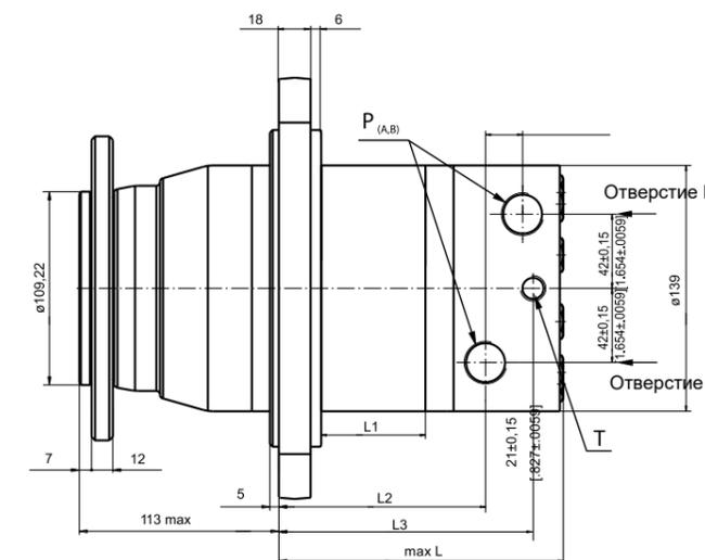
**P(A, B):** 2x1-1/16-12 UN, отверстие с уплотнительным кольцом глубиной 17 мм
