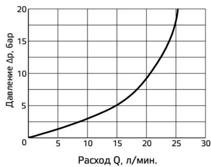
Типовые кривые р-Q рабочих пределов для максимальной гидравлической мощности, передаваемой клапанами EVX-\*-C5.
