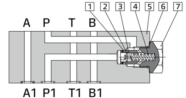
Жидкость свободно поступает по линиям A, B и T. В направлении P1 → P поток проходит через отверстие дросселя 3 (расход зависит от диаметра отверстия ØC). Когда разница давлений в P1 и P повышается, дроссель 3 перемещается к пружине 4 и снижает площадь боковых отверстий, поддерживая постоянный расход на требуемом уровне.
