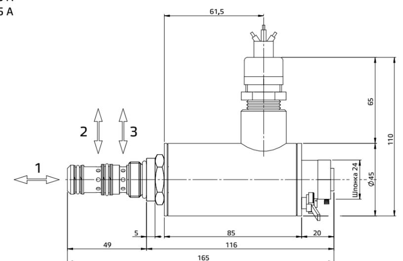
Гидравлические встраиваемые клапаны, взрывозащита  $\text{Ex}$  II 2 GD, Ex d IIC T5 **EVX-06-D5** 25 л/мин – 25 МПа (250 бар)
