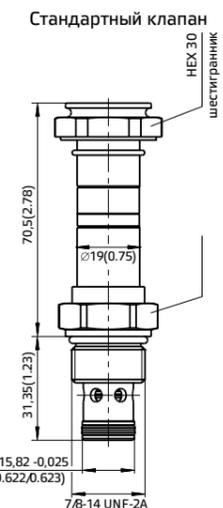
Клапаны EV2\*.78 устанавливаются в седло 7/8"-14 UNF. Проверьте соответствующее состояние и расположение уплотнений, затем заверните клапан в камеру и зафиксируйте путем затяжки шестигранника под ключ 27 мм с крутящим моментом приблизительно 45 Нм
