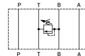
Жидкость свободно поступает по линиям А, В, Р и Т. Когда в рабочей линии, защиту которой обеспечивает клапан разгрузки, давление превышает установленное значение, поршень 1 выталкивается осевой гидравлической силой, преодолевает противодействие пружины 2, смещается в своем цилиндрическом седле и открывает кольцевой проход жидкости под давлением в линию Т, тем самым, поддерживая требуемый уровень давления
