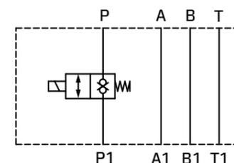
Выравнивание тарелки 3 обеспечивается давлением, и она удерживается в своем седле 4 пружиной 6. Когда на электромагнит подводится питание, подвижный якорь 9 перемещает тарелку 3 к пружине 6, открывая поток между P1 и P. Ручной регулятор 13 представляет собой штифт, который при нажатии на него приводит в действие клапан в случае сбоя электро питания.
