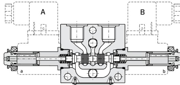
Комбинации золотников, пружины и электромагнитов позволяют реализовывать практически любые соединения и последовательности всех типов портов (Р, А, В, Т).
