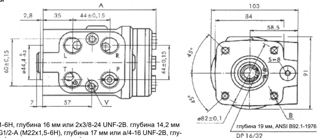
V: 2xM10x1-6H, глубина 16 мм или 2x3/8-24 UNF-2B, глубина 14,2 мм
