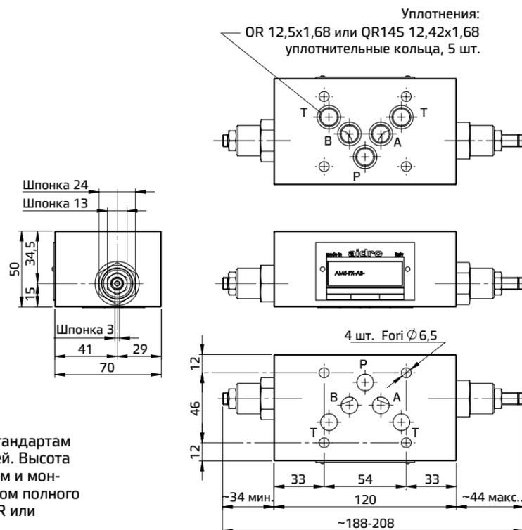
Обратные клапаны модульного монтажа AM5-CO-\* 100 л/мин – 32 МПа (320 бар)
