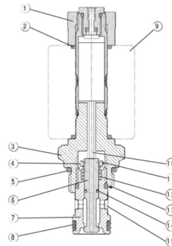
Тарелка 4 балансируется посредством давления и удерживается в нормально закрытом положении в седле 5 пружины 8. Когда к электромагниту подводится питание, подвижный якорь 7 перемещает тарелку 4 относительно пружины 8, пропуская поток между 2 и 1. Устройство ручного управления штифтового типа при нажатии обеспечивает работу клапана в случае сбоя электроснабжения.
