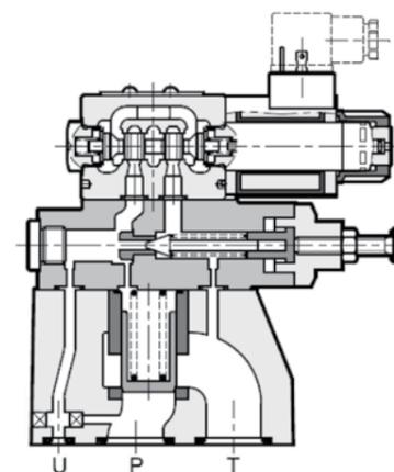
GMG\*-/40 – предохранительные клапаны с пилотным управлением, доступные в 5 версиях и максимум с 3 вариантами выбора значений давления. Для установки 2-го и 3-го значения клапан разгрузки давления должен быть установлен между основным клапаном и электромагнитным клапаном. Клапаны поставляются, как правило, с регулировочным винтом с шестигранной головкой (по запросу клапан оснащается рукояткой SICBLOC для регулировки основного давления).
