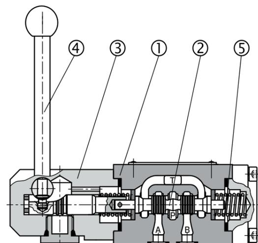
Гидравлические соединения, создаваемые в центральном (нейтральном) положении являются характеристическим признаком формы золотника, и на их основе выводится идентификационный номер: 0 = P, A, B, T соединены; 1 = P, A, B, T закрыты; 3 = P закрыт и A, B, T соединены;
