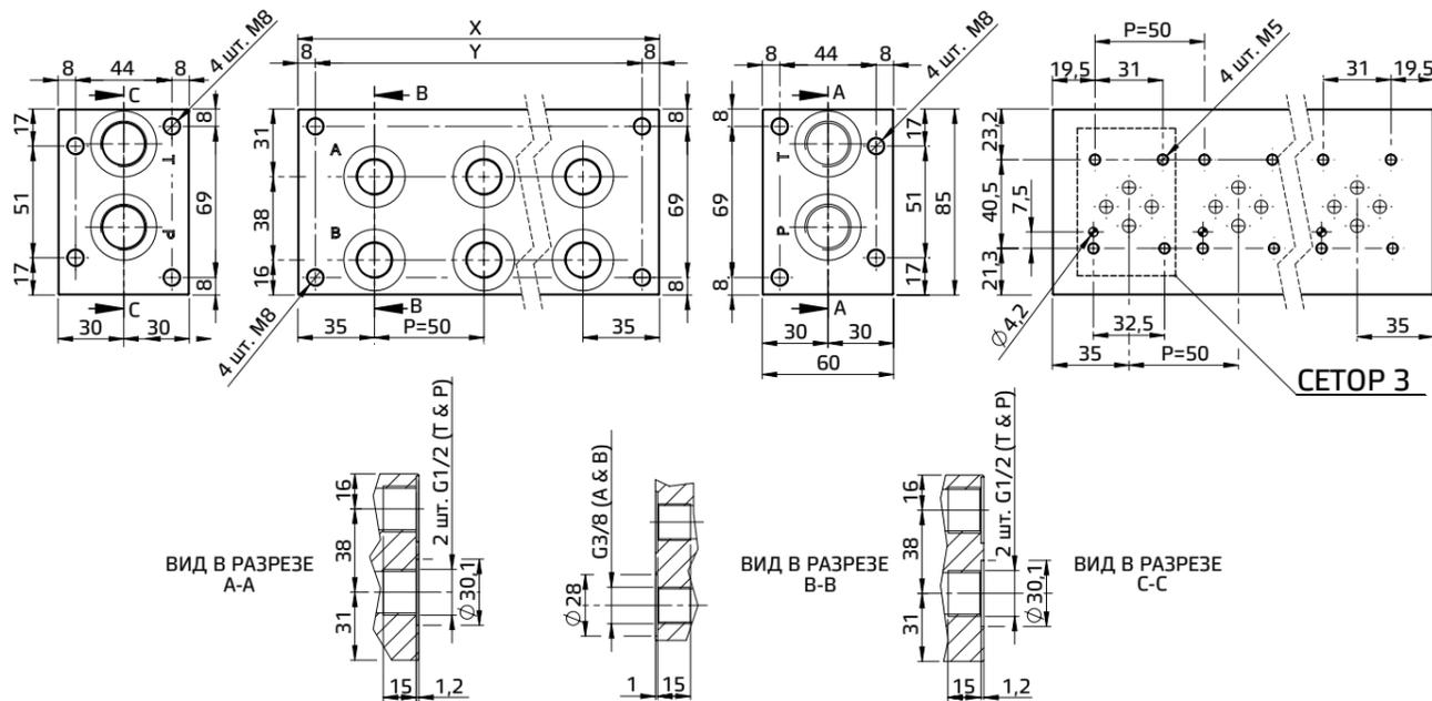
4 установочных отверстия с резьбой M8 на тыльной стороне
