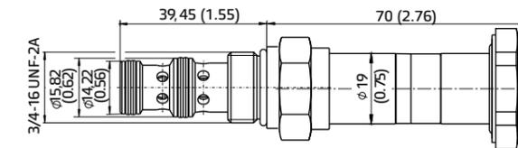
Клапаны EV3\*.34 устанавливаются в седло 3/4"-16 UNF. Проверьте соответствующее состояние и расположение уплотнений, затем заверните клапан в камеру и зафиксируйте путем затяжки шестигранника под ключ 24 мм с крутящим моментом приблизительно 45 Нм.
