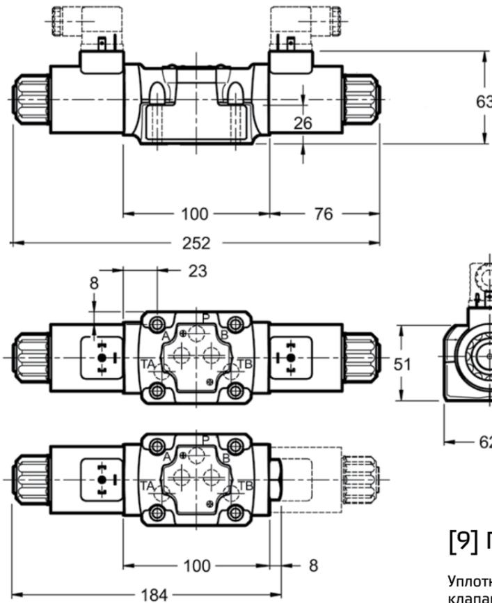
Все клапаны HD5-\* соответствуют стандартам ISO и СЕТОР для размеров монтажных поверхностей и высоты клапанов.
