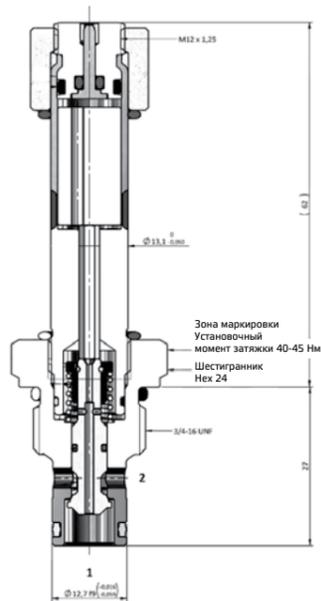
Клапаны EV\*.34 устанавливаются в седло 3/4"-16 UNF Ø12,7 мм. Проверьте соответствующее состояние и расположение уплотнений, затем заверните клапан в камеру и зафиксируйте путем затяжки шестигранника под ключ 24 мм с крутящим моментом приблизительно 45 Нм.
