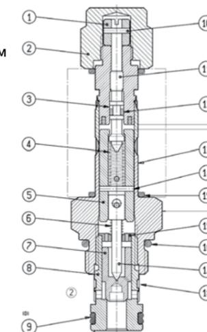
Тарелка 7 приводится в действие и удерживается в нормально закрытом положении в седле 8. Когда к электромагниту подводится питание, подвижный якорь 5 и управляющий штифт 17 смещаются, и тарелка, разбалансированная под действием давления, открывается, пропуская поток от 1 до 2.
