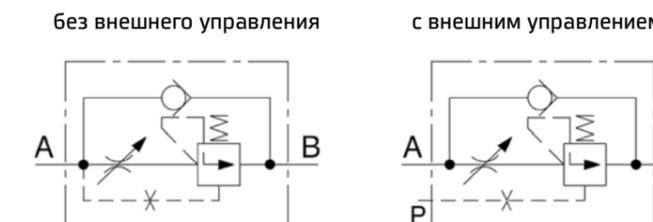
Клапан QVC-06/\*-E с внешним пилотным управлением используется для установки в контурах регулировки на входе для предотвращения резких скачков при запуске привода.
