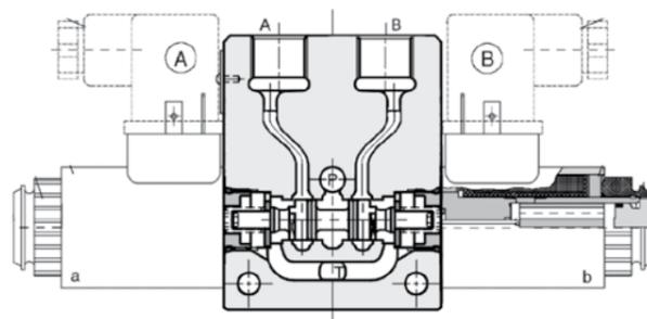
Комбинирование золотников, пружины и электромагнитов позволяет реализовывать практически любые соединения и последовательности всех типов портов (P, A, B, T).
