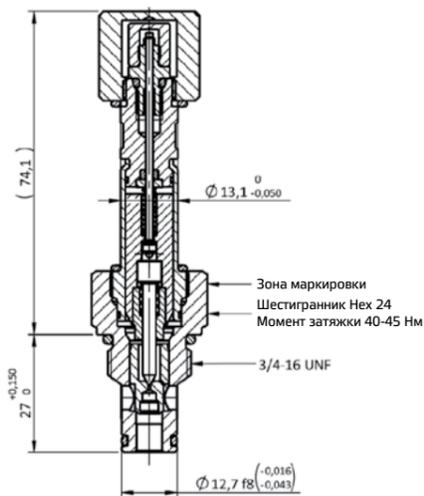
Клапаны EVSC.34 устанавливаются в седло 3/4" 16 UNF диаметром 12,7 мм. Проверьте соответствующее состояние и расположение уплотнений, входящих в комплект поставки клапана:
