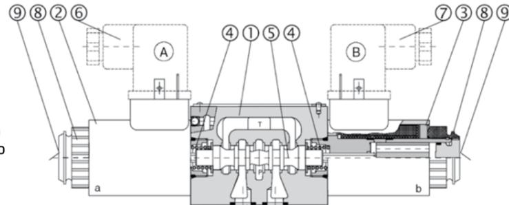
Золотник 5 смещается в корпусе клапана 1 под действием пружин 4 и электромагнитов 9. Золотник 5, в зависимости от его формы и положения в корпусе клапана 1, открывает и/или закрывает проходы между портами P, A, B и T, за счет чего регулируется направление гидравлического потока
