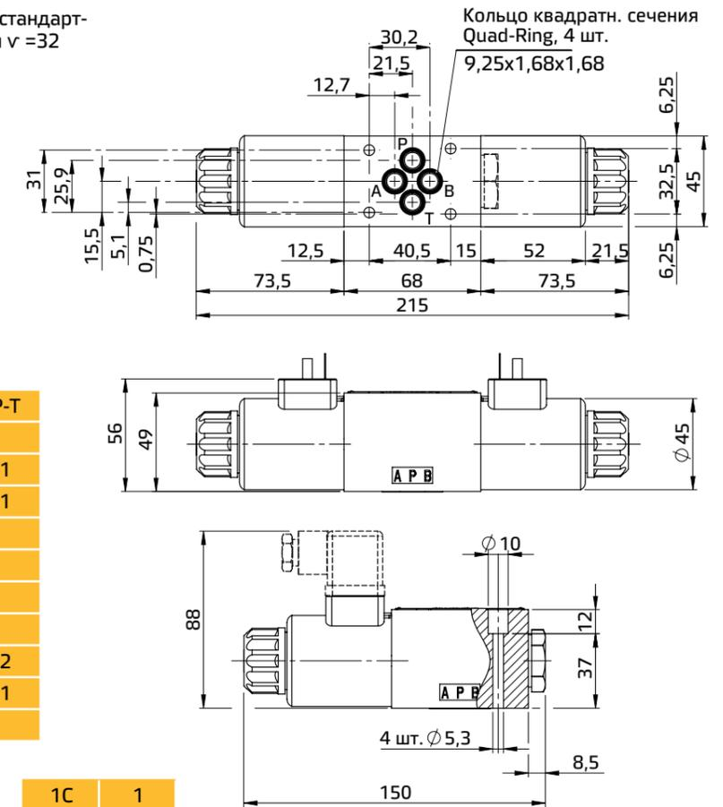
Все клапаны HD3-\* соответствуют стандартам ISO и СЕТОР для размеров монтажных поверхностей (см. 9) и высоты клапанов. При сборке на монтажной плите клапаны HD3-\* должны крепиться 4-мя болтами М5х45 (или М5х\*\*, в зависимости от количества модулей), затягиваемыми с применением крутящего момента 8 Нм.
