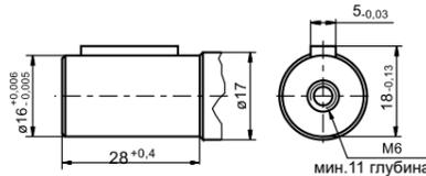
CK Ø 14 цилиндрическое, Призматическая шпонка 5x5x16 DIN 6885 Макс. Крутящий момент 4,4 даН.м
