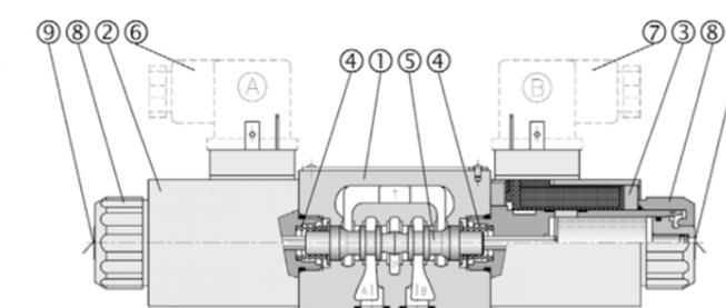
Золотник 5 смещается в корпус клапана 1 под действием пружин 4 и электромагнитов 2. Золотник 5, в зависимости от его формы и положения в корпусе клапана, открывает и/или закрывает проходы между портами P, A, B и T, за счет чего регулируется направление гидравлического потока
