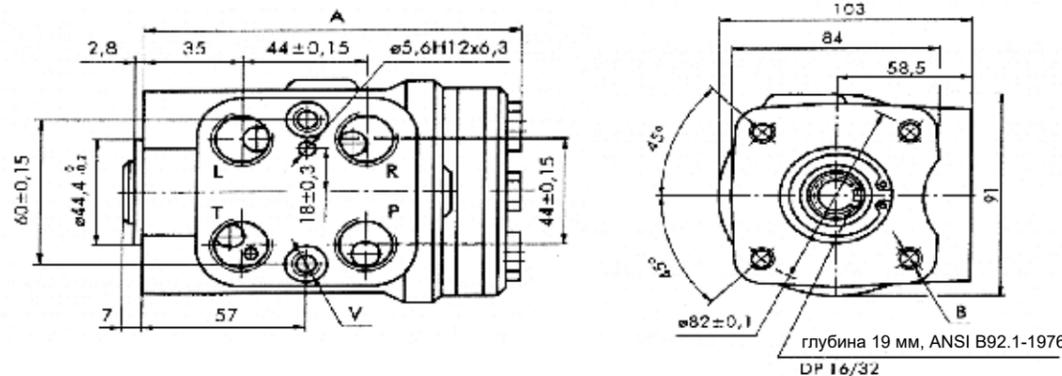
V: 2xM10x1-6H, глубина 16 мм или 2x3/8-24 UNF-2B, глубина 14,2 мм
