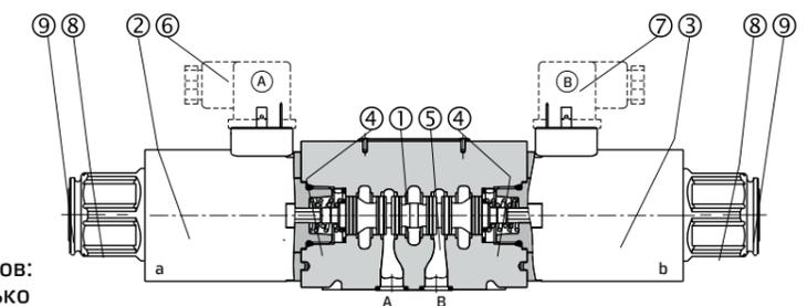
Золотник 1 смещается в корпус клапана 7 под действием пружин и электромагнитов 2 и 3. Золотник 1, в зависимости от его формы и положения в корпусе клапана 7, открывает и/или закрывает проходы между портами P, A, B и T, за счет чего регулируется направление гидравлического потока. В случае отключения электроэнергии золотник можно перемещать вручную при помощи штифтов ручного управления 9, расположенных на торцевой стороне электромагнитов и доступных посредством зажимных гаек.
