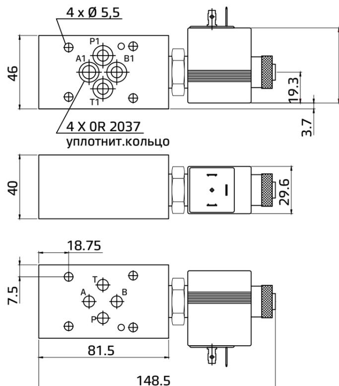
Все модульные клапаны AM3-\* соответствуют стандартам ISO и СЕТОР для размеров монтажных поверхностей и для высоты клапанов (40 мм). Утечка между клапаном и монтажной поверхностью предотвращается посредством полного прижима к седлам 4 уплотнительных колец типа OR 2037.
