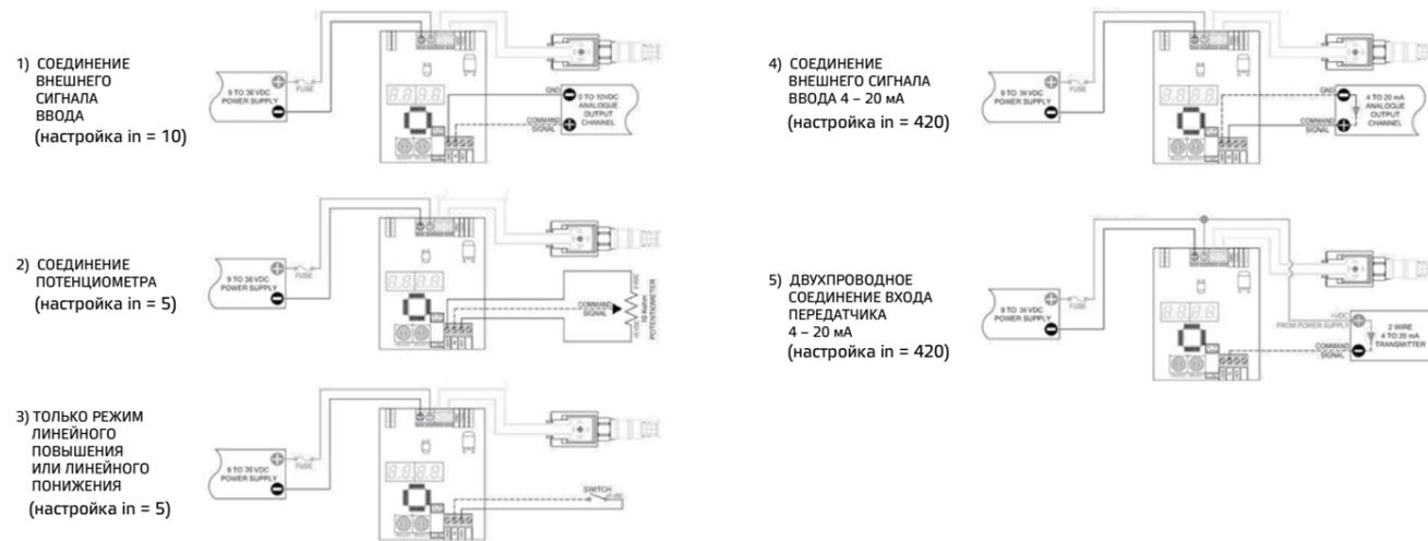
Примечание: Для драйверов с командным входом 0–5 В постоянного тока или 0–10 В постоянного тока рекомендуется использовать независимые отрицательные провода для источника питания и для аналогового выходного канала (ПЛК/ПК), чтобы поддерживать точность командного сигнала в случае перепада напряжения в кабелях большой длины.
