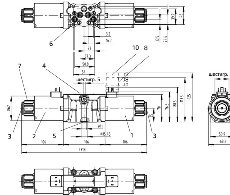
Все клапаны HD5-ES-\* соответствуют стандартам ISO и СЕТОР для размеров монтажных поверхностей и высоты клапанов.
