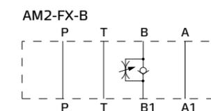
Жидкость поступает свободно по линиям P и T. В рабочих линиях A и/или B с регуляторами жидкость поступает в направлении A → A1 (и/или B → B1), преодолевая усилие пружины, действующее на втулку. Жидкость поступает в направлении A1 → A (и/или B1 → B) через отверстия втулки, вдавливаемой в седло. Дросселирующая ось, смещаемая путем завинчивания и блокировки при помощи гайки, частично преграждает регулирующие отверстия, за счет чего расход полностью зависит от действующего перепада давлений.
