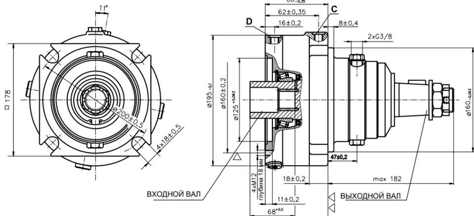
**C** Ø40 цилиндрический, Призматическая шпонка A12x8x70 DIN6885
