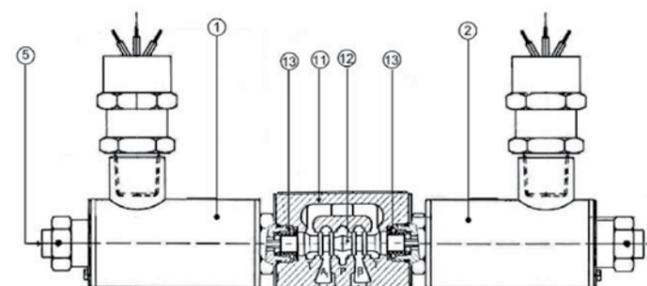
Золотник 12 смещается в корпус клапана 11 под действием пружин 13 и электромагнитов 2. Золотник 12, в зависимости от его формы и положения в корпусе клапана, открывает и/или закрывает проходы между портами P, A, B и T, за счет чего регулируется направление гидравлического потока
