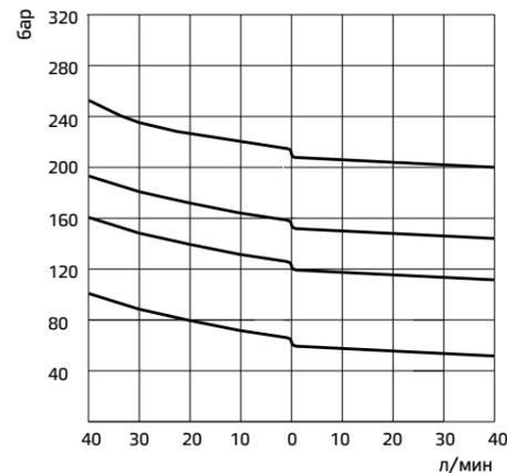
Все клапаны АМЗ-РР-\* – 3-линейные, прямого действия. Если давление в регулируемой камере превышает значение регулируемого понижаемого давления, клапан осуществляет слив в линию Т (при давлении выше понижаемого давления, см. графики), при этом он действует как предохранительный или разгрузочный клапан. Редукционные клапаны давления оснащены встроенным обратным клапаном 9 (типы АМЗ-РР-АС или ВС) в линиях А или В, и обеспечивают создание обратного потока в порт А или В электромагнитного клапана.
