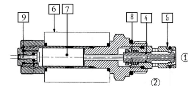
Тарелка 4 балансируется посредством давления и удерживается в нормально закрытом положении в седле 5 пружины 8. Когда к электромагниту подводится питание, подвижный якорь 7 перемещает тарелку 4 относительно пружины 8, пропуская поток между 2 и 1. Устройство ручного управления штифтового типа при нажатии обеспечивает работу клапана в случае сбоя электроснабжения.
