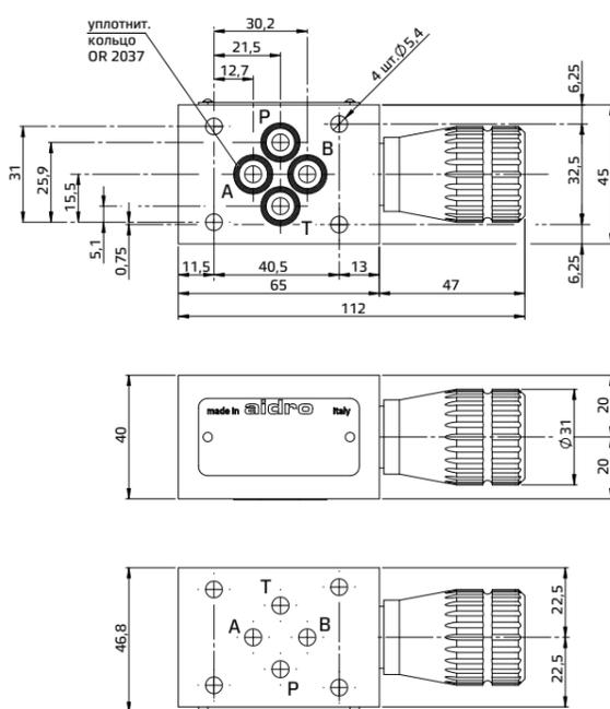
Все модульные клапаны AM3-Q\* соответствуют стандартам ISO и CETOP для размеров монтажных поверхностей и для высоты клапанов 40 мм. Утечка между клапаном и монтажной поверхностью предотвращается посредством полного прижима к седлам 4 уплотнительных колец типа OR 2037.
