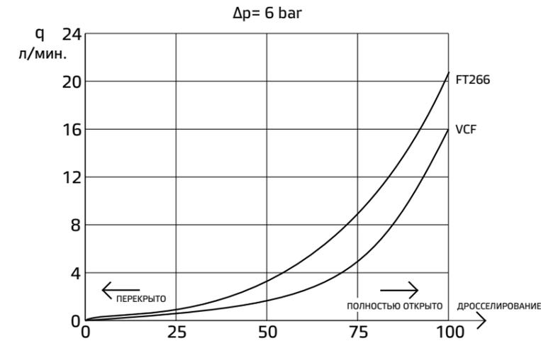
Типовые графики Q для различных секций дросселирования и фиксированный перепад давлений Δp = 6 бар для клапанов FT266/VCF. Стандартная конфигурация с минеральным маслом при v = 42 сСт и 50°C.
