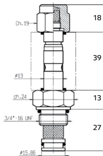
Клапаны EVSC.34/2 устанавливаются в седло 3/4"-16 UNF диаметром  $\phi 15,87$  мм. Проверьте соответствующее состояние и расположение уплотнений, входящих в комплект поставки клапана:
