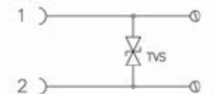
По запросу катушки могут поставляться со встроенным симметричным гасящим диодом (переходный диод типа BZW06-19B), обеспечивающим защиту от высоких перенапряжений. Благодаря мгновенной реакции таких диодов на кратковременные перенапряжения они оптимально подходят для защиты устройств, чувствительных к напряжению.
